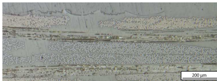
FIGURE 6.5 – Vue en coupe (MO) du substrat M26TE/K
